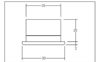
LED-Lichtpunkt, IP43, chrom, rund. Ausgeführt in kompakter Bauform für werkzeuglose Schnellmontage zum Deckeneinbau-
