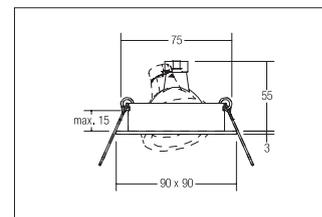
Einbaustrahler, GX5,3, alu matt, quadratisch. Ausgeführt in kompakter Bauform für werkzeuglose Schnellmontage zum Decken-einbauAusführung: GX5,3, Montageart: Einbaumontage, Montageort: Deckenmontage, Material: Aluminium, Schutzart: nach DIN EN 60529: IP20, Schutzklasse: (EN 61140) III, Spannung: 12V, Leistung: 50W, Anzahl der Leuchtmittel / Fassungen: 1.0 Stk, Verstellbarkeit: schwenkbar, ohne Betriebsgerät, Art der Dimmung: abhängig vom Betriebsgerät .
