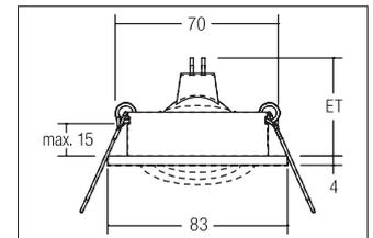
Einbaustrahler, GX5,3, nickel matt, rund. Ausgeführt in kompakter Bauform für werkzeuglose Schnellmontage zum Deckeneinbau. Ausführung: ohne Fassung, Montageart: Einbaumontage, Montageort: Deckenmontage, Material: Aluminiumguss, Schutzart: nach DIN EN 60529: IP20, Schutzklasse: (EN 61140) III, Spannung: 12V, Leistung: 50W, Anzahl der Leuchtmittel / Fassungen: 1.0 Stk, Verstellbarkeit: schwenkbar, ohne Betriebsgerät, Art der Dimmung: abhängig vom Betriebsgerät .
