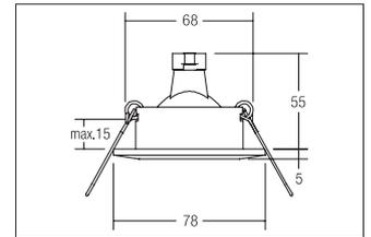
Einbaudownlight, chrom, rund. Ausgeführt in kompakter Bauform für werkzeuglose Schnellmontage zum DeckeneinbauAusführung: GX5,3, Montageart: Einbaumontage, Montageort: Deckenmontage, Material: Aluminiumguss, Schutzart: nach DIN EN 60529: IP20, Schutzklasse: (EN 61140) III, Spannung: 12V, Leistung: 50W, Anzahl der Leuchtmittel / Fassungen: 1.0 Stk, Verstellbarkeit: nicht verstellbar, ohne Betriebsgerät, Art der Dimmung: abhängig vom Betriebsgerät .
