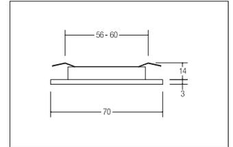
LED-Einbaudownlightset, alu matt, rund. Ausgeführt in kompakter Bauform für werkzeuglose Schnellmontage zum Deckeneinbau. Leuchtsset optimiert zur Installation in Möbeln und Holzwerkstoffen mit 3 x Leuchten mit je 2.000 mm Anschlussleitung, 1 x Verteiler und 1 x Netzgerät für 230 V-Netzspannung, schaltbar, Maße Netzgerät: L 105 x B 49 x H 18 mm.
