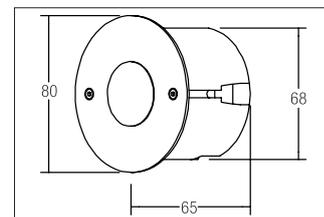
LED-Wandeinbauleuchte, IP20, edelstahl, rund. Einbaumontage, Wandmontage. inkl. Konverter zum Anschluss an 230 V-Netzspannung,
