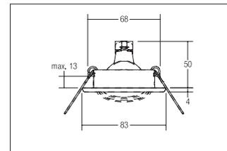
Einbaustrahler, GX5,3, edelstahl, rund. Ausgeführt in kompakter Bauform für werkzeuglose Schnellmontage zum Deckeneinbau. Ausführung: GX5,3, Montageart: Einbaumontage, Montageort: Deckenmontage, Material: Edelstahl, Schutzart: nach DIN EN 60529: IP20, Schutzklasse: (EN 61140) III, Spannung: 12V, Leistung: 50W, Anzahl der Leuchtmittel / Fassungen: 1.0 Stk, Verstellbarkeit: schwenkbar, ohne Betriebsgerät, Art der Dimmung: abhängig vom Betriebsgerät .
