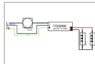
LED-Netzgerät 24 V DC, dimmbar.. Material: Kunststoff, Schutzart raumseitig: nach DIN EN 60529: IP20, Schutzklasse: (EN 61140) II, Spannung: 24V, Leistung: 120W, Art der Dimmung: Phasenabschnitt.
