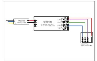
RGB-Tischfernbedienung zu 18192000. RGB-Tischfernbedienung zur Ansteuerung von RGB-LED-Modulen im Farblichtbereich.
