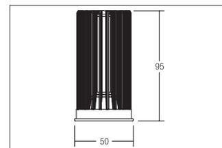
LED-Reflektoreinsatz MR16, 12,5 W, SunLike, CRI > 97, 350 mA.. Ausführung: Plug&Play, Material: Aluminium / Kunststoff, Schutzart raumseitig: nach DIN EN 60529: IP20, Schutzklasse: (EN 61140) III, Leistung: 12.5W, Lichtstrom: 920lm, Farbtemperatur: 3.000 K, Lichtfarbe: weiß, Abstrahlwinkel: 38°, Art der Dimmung: abhängig vom Betriebsgerät.
