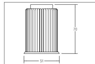
LED-Reflektoreinsatz MR16, 12 W, 350 mA, rund.. Ausführung: Plug&Play, Material: Aluminium / Glas, Schutzart raumseitig: nach DIN EN 60529: IP20, Schutzklasse: (EN 61140) III, Leistung: 12W, Lichtstrom: 1.240lm, Farbtemperatur: 3.500 K, Lichtfarbe: weiß, Abstrahlwinkel: 38°, Art der Dimmung: abhängig vom Betriebsgerät.
