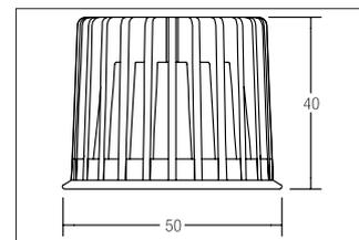
LED-Reflektoreinsatz MR16, 3 W, 350 mA, rund.. Ausführung: Plug&Play, Material: Aluminium / Glas, Schutzart raumseitig: nach DIN EN 60529: IP20, Schutzklasse: (EN 61140) III, Leistung: 3W, Lichtstrom: 340lm, Farbtemperatur: 4.000 K, Abstrahlwinkel: 38°, Art der Dimmung: abhängig vom Betriebsgerät.
