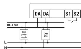
Standardbetrieb mit zusätzlicher Ansteuerung durch Schließtaster. Bei Bedarf kann das Licht durch den Taster manuell gedimmt oder ein bzw. ausgeschaltet werden.
