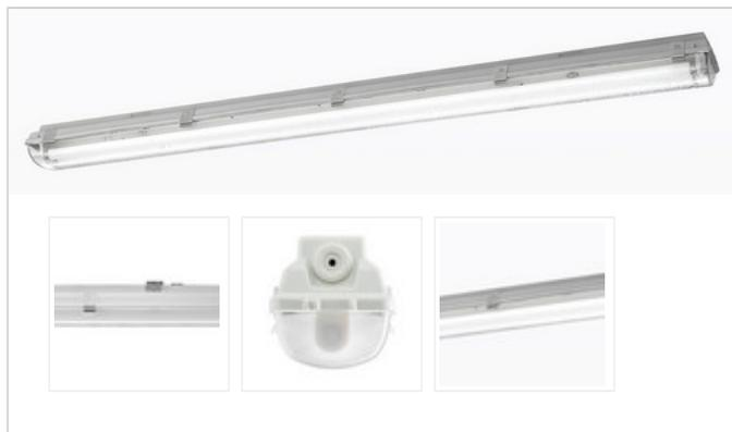
Feuchtraum Wannenleuchte für T8 LL mit Wanne aus PC, Leuchtenunterteil aus grauem, glasfaserverstärktem Polyester, rundumlaufende Silikondichtung, Lieferung inkl. Deckenbefestigungsclip, Verschluss-Clip aus rostfreiem Edelstahl, Reflektor aus Metall, weiß lackiert, Durchgangsverdrahtung mit optionalem Set möglich, mit Leitungseinführung stirn- und deckenseitig, geeignet für Deckenmontage; Pendel-, Tragschienen und waagerechte Wandmontage mit Zubehör möglich.
