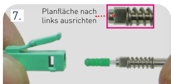
Abb. 7/8: LC/APC Steckergehäuse anbringen
