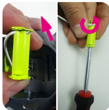
Abb.3/4: Kabel in Spule einführen, aufwickeln
