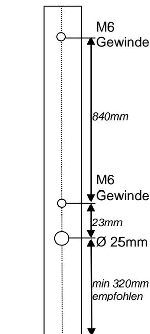
Am Mast müssen in der in der Skizze angegebenen Abständen M6 Gewinde, vorzugsweise mittels Gewindenieten angebracht werden. Darunter muss das Loch für die Kabeldurchführung im richtigen Abstand angebracht werden.
