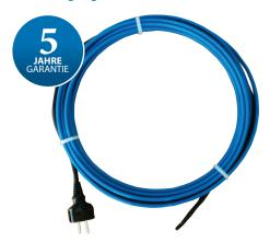
DEVIpipeheat™ 10 (DPH) ist ein steckfertig konfektioniertes, selbstbegrenzendes Parallelheizband, dessen temperaturabhängiges Widerstandselement die Heizleistung reguliert und begrenzt. Dieser Prozess vollzieht sich – abhängig von der Umgebungstemperatur – an jeder Stelle des Heizbandes. Die Verlegung erfolgt auf der Oberfläche des zu schützenden Rohres.
