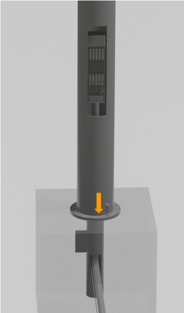
Abbildung 4: montierte Doppelstele mit KÜK
