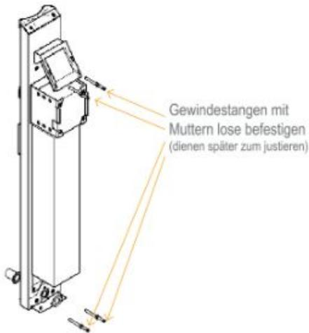
Abbildung 7: Einstellung der Justierbolzen
