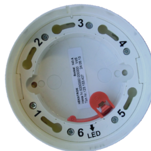
Abb. 6: Der Magnet muss auf Klemme 5 im Sockel eingesetzt werden. Dadurch werden die im Rauchschalter integrierten Abschlusswiderstände über Reedkontakte aktiviert. Wird der Magnet nicht eingesetzt, hat der Rauchschalter wie gewohnt seinen potentialfreien Öffner.
