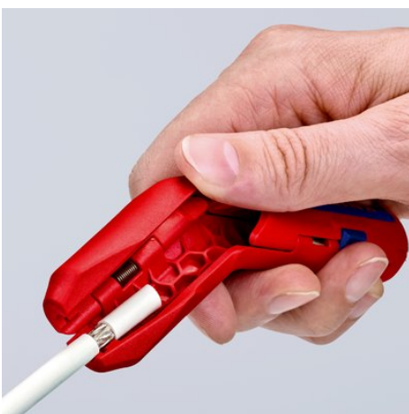
Abmanteln eines Koaxialkabels
