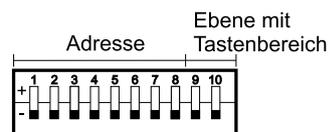
In Werkseinstellung bildet der FS3 HS die Tasten 1-4 der Ebene A nach (bezogen auf die Schalk Sender mit 8 Sendetasten)
