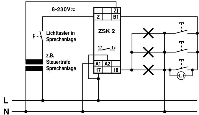
Anschluss einer Sprechanlage
