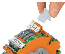
Durch Verwendung von Verriegelungskappen oder -profilen wird eine gleichzeitige Betätigung von Trennhebeln nebeneinander liegender Klemmen vereinfacht.
