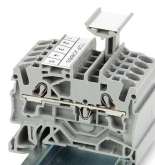
TOPJOB*S-Gruppenschildträger (Bestellnr. 2009-193) hier bestückt mit Beschriftungsstreifen, verwendbar für alle TOPJOB*S-Reihenklammern der Serien 2000 bis 2016. Nicht über eine Abschlussplatte hinweg setzen!
