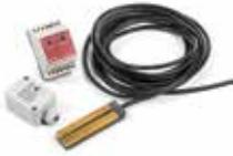
Der Fühler RAYSTAT-M2-R-SENSOR wird in Dachrinnen und Fallrohren montiert. Der RAYSTAT-M2-R-SENSOR misst die Feuchtigkeit und der RAYSTAT-M2-A-SENSOR die Temperatur. Die Freiflächenbeheizung wird nur eingeschaltet, wenn die Außentemperatur unter dem eingestellten Sollwert liegt und der Fühler RAYSTAT-M2-R-SENSOR Feuchtigkeit misst.
