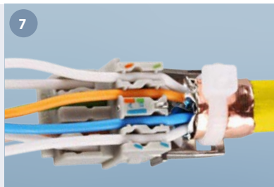
7 Adern in oberen Teil des Adersortierers entsprechend dem Farbcode eindrücken. Push in the wires according to the colour code in the upper part of cable sorter.
