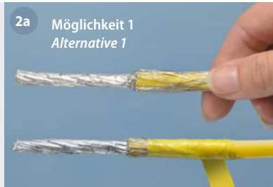
2a Möglichkeit 1 Alternative 1 Schirmgeflecht zurückschieben und mit Isolierband fixieren. Push back the copper braid and fix it with tape.
