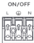
Abb.: 4 Anschlusschema: Dali oder schaltbar
