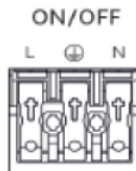
Abb.: 4 Anschlusschema: Dali oder schaltbar
