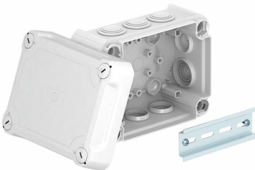
Kabelabzweigkasten zum Verbinden von Kabeln und Leitungen im Innenbereich und geschützten Außenbereichen. Rechteckige Form mit Einstechdichtungen an den Seiten und Ausschlägeöffnungen im Boden. Geeignet für die Wand-/ Deckenmontage und die Montage auf Montageblechen. Mit der Möglichkeit zur Innenbefestigung und Montage über die Eckdome. Hoher Deckel mit Schnellverschluss, plombierbar. Hergestellt aus halogenfreien und UV-resistenten Materialien.
