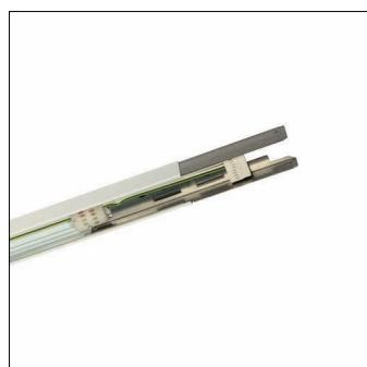
Modario IP64, Tragschiene, aus Stahlblech, verzinkt, lackiert, leuchtenweiß, 3längig, Länge: 4.485 mm, Breite: 58 mm, Höhe: 43mm, Durchverdrahtung: 5x 2,5mm<sup>2</sup>, mit Klemme, 5polig, max. 2,5mm<sup>2</sup>, Schutzart (gesamt): für Schutzart IP64, Schutzklasse (gesamt): SK I (Schutzerdung), Prüfzeichen: CE, ENEC, VDE, Norm: EN 60598, Verpackungseinheit: 1 Stück
