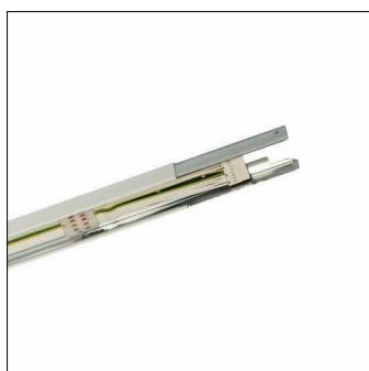
Modario, Tragschiene, aus Stahlblech, lackiert, leuchtenweiß, 2längig, Länge: 2.990 mm, Breite: 58 mm, Höhe: 43mm, Durchverdrahtung: 10x 2,5mm<sup>2</sup>, mit Klemme, 10polig, max. 2,5mm<sup>2</sup>, Schutzart (gesamt): für Schutzart IP20/IP40, Schutzklasse (gesamt): SK I (Schutzerdung), Prüfzeichen: CE, ENEC, VDE, Norm: EN 60598, Verpackungseinheit: 1 Stück
