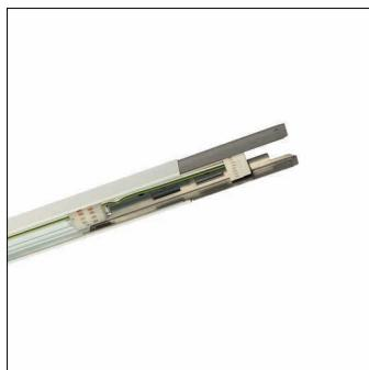
Modario, Tragschiene, aus Stahlblech, lackiert, leuchtenweiß, 2längig, Länge: 2.990 mm, Breite: 58 mm, Höhe: 43mm, Durchverdrahtung: 5x 2,5mm<sup>2</sup>, mit Klemme, 5polig, max. 2,5mm<sup>2</sup>, Schutzart (gesamt): für Schutzart IP20/IP40, Schutzklasse (gesamt): SK I (Schutzerdung), Prüfzeichen: CE, ENEC, VDE, Norm: EN 60598, Verpackungseinheit: 1 Stück
