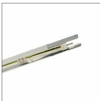
Modario, Tragschiene, aus Stahlblech, lackiert, leuchtenweiß, 1längig, Länge: 1.495 mm, Breite: 58 mm, Höhe: 43mm, Durchverdrahtung: 10x 2,5mm<sup>2</sup>, mit Klemme, 10polig, max. 2,5mm<sup>2</sup>, Schutzart (gesamt): für Schutzart IP20/IP40, Schutzklasse (gesamt): SK I (Schutzerdung), Prüfzeichen: CE, ENEC, VDE, Norm: EN 60598, Verpackungseinheit: 1 Stück
