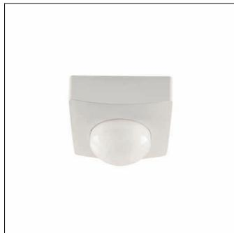
SITECO ConnectSensor-Head PR2-S, Slave, lokale Steuerung - autarke standalone Sensorik, zentrale Steuerung - Anbindung an Licht- oder Gebäudemanagement, dimmbar, Montageart: Einstechmontage, Montageort: an der Decke, an der Modario Tragschiene, an der Licross Tragschiene, aus Kunststoff, Schutzart (gesamt): IP54, Prüfzeichen: CE, VDE, 1 x PIR-Bewegungssensor, 1 x Lichtsensor, Verpackungseinheit: 1 Stück
