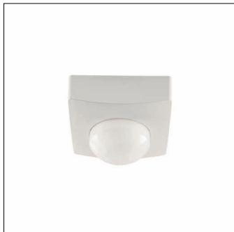
SITECO ConnectSensor-Head PC5-M, Master, lokale Steuerung - autarke standalone Sensorik, schaltbar, dimmbar, Montageart: Einstechmontage, Montageort: an der Licross Tragschiene, an der Modario Tragschiene, an der Decke, aus Kunststoff, Schutzart (gesamt): IP54, Prüfzeichen: CE, VDE, 1 x PIR-Bewegungssensor, 1 x Lichtsensor, 1 x IR-Empfänger, Verpackungseinheit: 1 Stück
