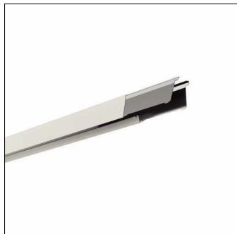
Licross, Tragschiene, aus Stahlblech, verzinkt, bandlackiert, weiß, Länge: 4.500 mm, Breite: 64 mm, Höhe: 67mm, Durchverdrahtung: 7x 2,5mm<sup>2</sup>, Schutzart (gesamt): maximal IP64, abhängig von den verwendeten Einsätzen und Zubehören, Schutzklasse (gesamt): SK I (Schutzerdung), Prüfzeichen: CE, UKCA, LABS-Konformität geprüft gemäß VDMA 24364:2018-05, Verpackungseinheit: 1 Stück
