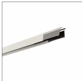
Licross, Tragschiene, aus Stahlblech, verzinkt, bandlackiert, weiß, Länge: 4.500 mm, Breite: 64 mm, Höhe: 67mm, Durchverdrahtung: 5x 2,5mm<sup>2</sup>, Schutzart (gesamt): maximal IP64, abhängig von den verwendeten Einsätzen und Zubehören, Schutzklasse (gesamt): SK I (Schutzerdung), Prüfzeichen: CE, UKCA, LABS-Konformität geprüft gemäß VDMA 24364:2018-05, Verpackungseinheit: 1 Stück
