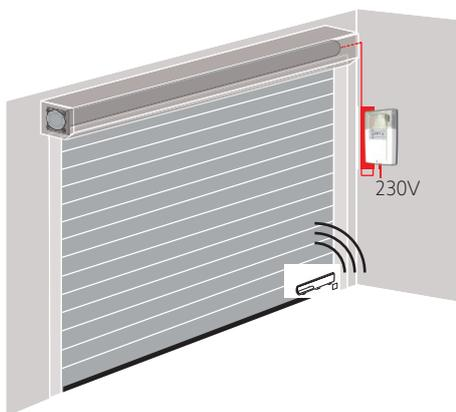
Der optionale Sicherheitsleisten-Sender ermöglicht den Betrieb ohne Kabel zwischen Steuerung und Sicherheitsleiste.
