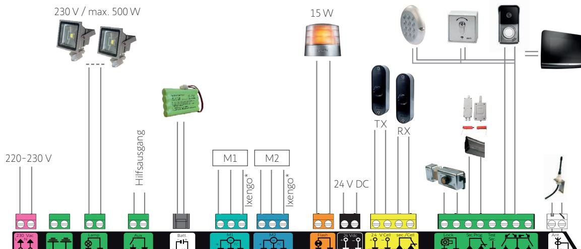
\* Anschlussklemmen für die Verdrahtung der Endlagen von Ixengo-Antrieben.
