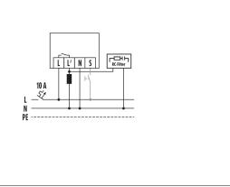
$Standard betrieb \ mit\ optionaler\ Ansteuerung\ durch\ Schließ taster\ und\ Parallels chaltung\ von\ max.\ 8\ Ger\"{a}ten$
