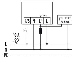
Standardbetrieb mit optionaler Ansteuerung durch Schließlasten und Verwendung von max. 10 Slave-Geräten an einem Master-Gerät.
