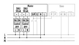
$Standard betrieb\ mit\ optionaler\ Ansteuerung\ durch\ Schließtaster\ und\ Verwendung\ von\ max.\ 10\ Slave-Ger\"{a}ten\ an\ einem\ Master-Ger\"{a}t.$
