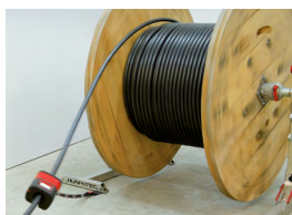
RM35 mit RUNPOLIFER L1600 und 3 x 35 mm² Kabel
