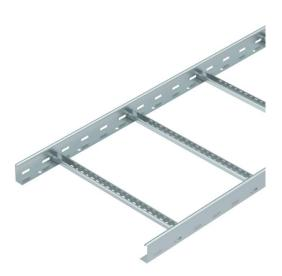
Kabelleiter mit gelochtem Seitenholm in der Seitenhöhe 60 mm mit eingenieteten, nach oben offenen C-Profil-Sprossen (Ausführung VS). Die Kabelleiter wird in zusammengeklappter Ausführung geliefert.
