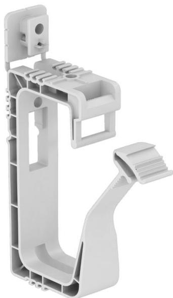
Sammelhalterung mit angespritztem Befestigungselement, zum Montieren von bis zu 40 Leitungen NYM 3 x 1,5 mm<sup>2</sup> an Wand oder Decke. Befestigung mit Schlagdübel oder Steckdübel. Auch geeignet zum Befestigen mit gas- und akku-betriebenen Setzgeräten der Marken Bosch, Fischer und Spit (Nasendurchmesser innen Ø 7 mm). Befestigungsloch Ø 6 mm. Empfohlener Befestigungsabstand bei voller Belegung 250-400 cm, abhängig von den jeweilig gültigen nationalen Vorgaben/Normen.
