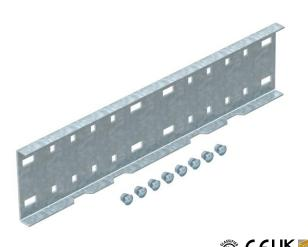
Längsverbinder für gerade Verbindungen von Formteilen, Weitspannkabelrinnen und -leitern mit 110 mm Seitenhöhe. Inklusive anteiliger Schrauben, Scheiben und Muttern.
