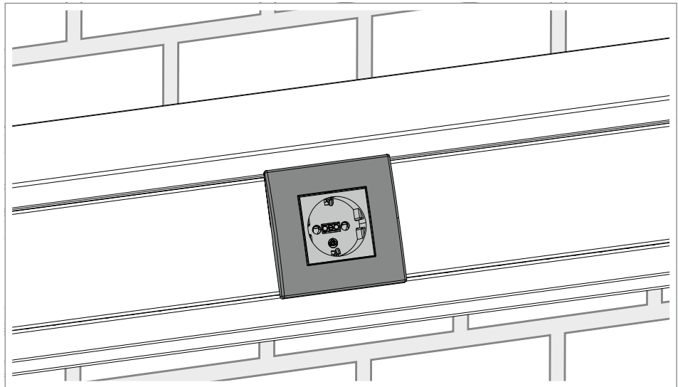
Abb. 13: Oberteil und Abdeckrahmen montieren
